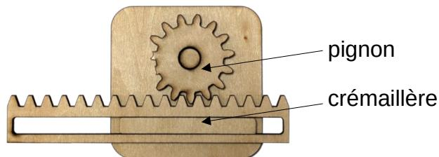
Pour transformer le mouvement de rotation en mouvement de translation rectiligne, un système pignon-crémaillère est utilisé dans le portail automatique.
