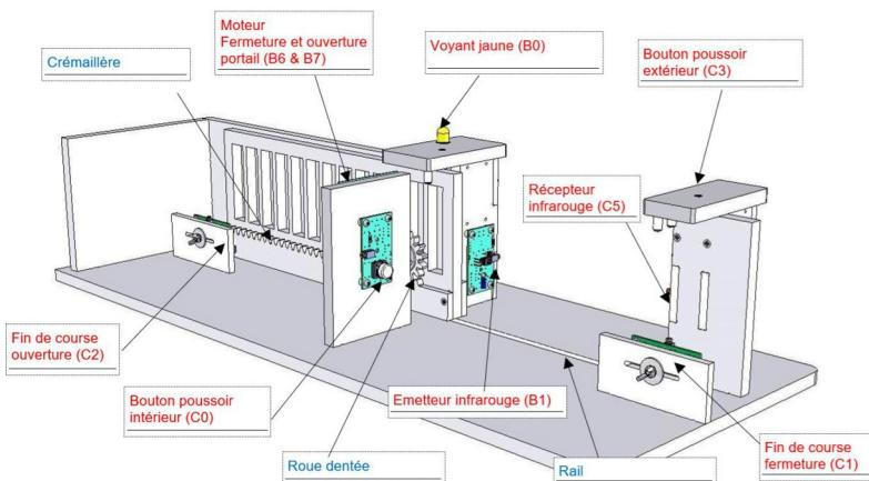
Le portail automatique attend l'appui sur un des boutons pour s'ouvrir, il s'arrête quand le capteur de fin de course Ouverture est activé. Après 10 secondes le portail se ferme et s'arrête quand le capteur de fin de course Fermeture est activé.
