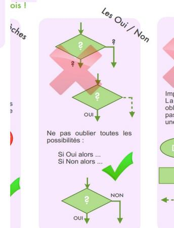
4. Lorsque qu'il y a un évènement (losange) il faut de suite placer le « oui » et le « non » pour ne pas oublier une solution.
