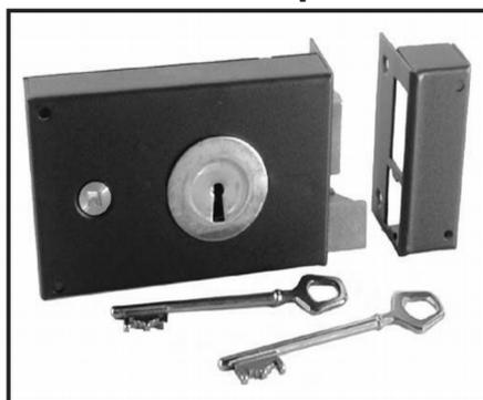
Une serrure à garnitures est constituée de composants métalliques. Le profil de la clé doit correspondre à la disposition des garnitures pour pouvoir tourner et déverrouiller le mécanisme. Ce système date de l'antiquité.
