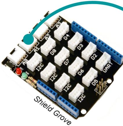
Les capteurs analogiques se connectent sur les entrées analogiques de A0 à A5
