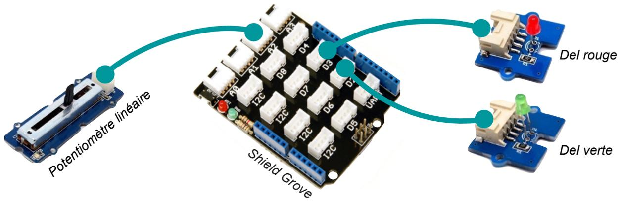
Acquisition de l'entrée analogique A2 dans la variable « mesure »
