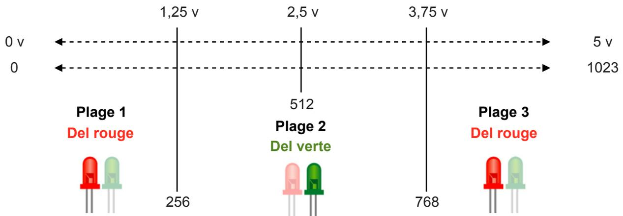
Dans l'exemple suivant, le programme permet d'allumer une del verte uniquement si la mesure de l'acquisition sur l'entrée analogique est comprise dans la plage 2. C'est à dire entre la valeur numérique 256 et 768. Dans le cas contraire si la mesure est située dans plage 1 et plage 3, c'est une del rouge qui s'allume.
